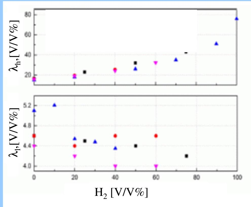
Gyulladási határok metán-hidrogén keverékek esetén, különböző mérési módszerekkel meghatározva
