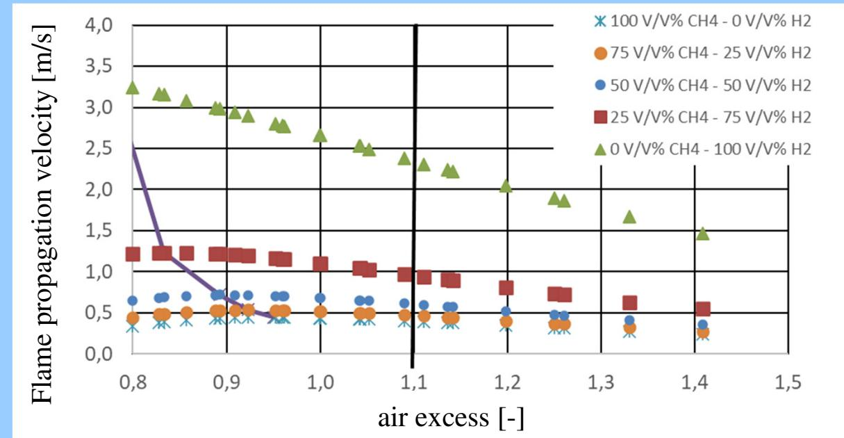
A lamináris lángrajzás sebesség függvényében különböző  $\text{H}_2$  bekeverés esetén (GRI 3.0 mechanizmus,  $T_0 = 323 \text{ K}$ ,  $P_0 = 0,1 \text{ Mpa}$ )
